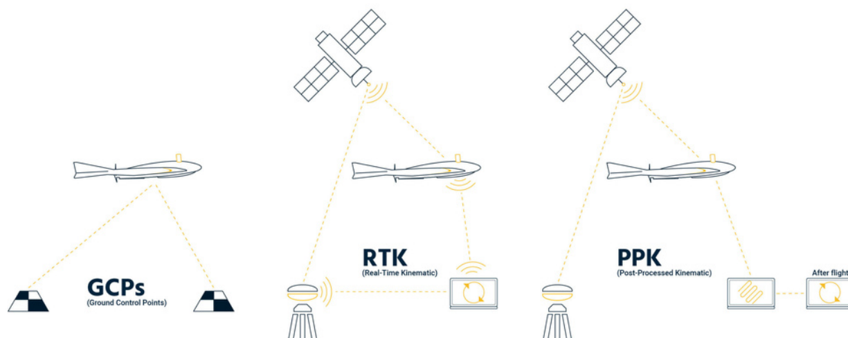
Figura 1. Métodos de georreferenciación para el mapeo con drones (Fuente: www.ageagle.com/blog )
