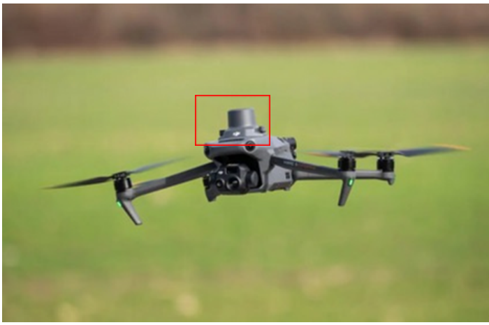
Figura 2. Tamaño de receptores GNSS con módulo RTK en drones (recuadro rojo) (Fuente: www.drohnen-camp.de )
