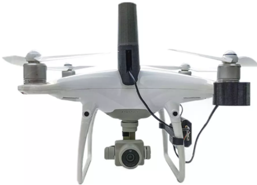
Figura 2. Dron convencional con modulo PPK adaptado (Fuente: www.images.app.goo.g )
