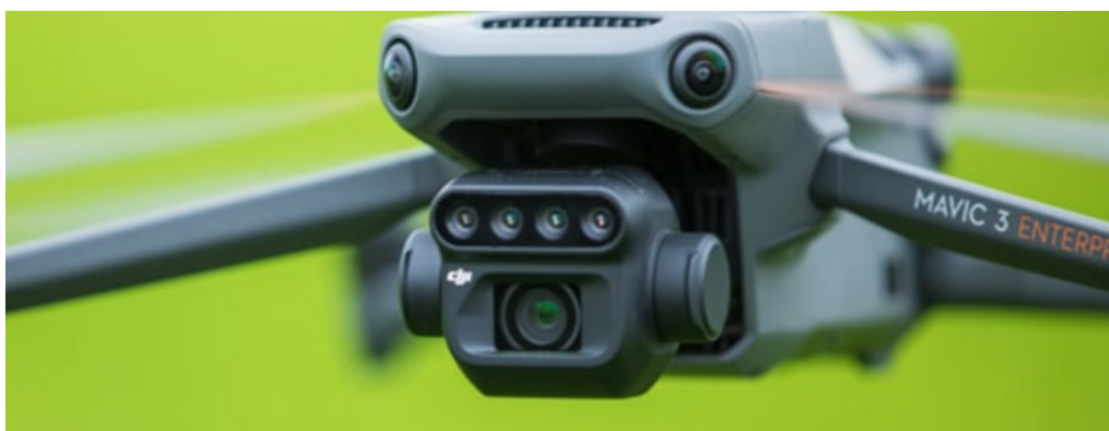
Figura 2. Sensores RGB y Multiespectral integrados a una misma carga útil (Fuente: www.enterprise-insights.dji.com )
