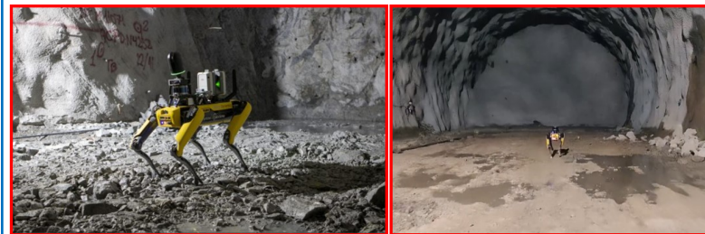
Figura 3. Perro robot Boston Dynamics en minera Chuquicamata, con integración de diversos equipos: cámaras fotográficas, térmicas, escáner, etc. (Fuente: https://www.mch.cl/2022/01/18/chuquicamata-asi-apuesta-por-mayor-autonomia-y-seguridad-en-sus-procesos/# )
