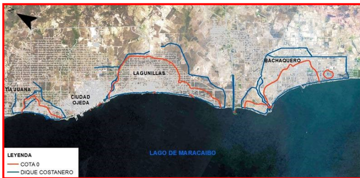
Figura 2. Pólderes de subsidencia y el SPCI (Sistema de Protección Contra Inundaciones)
