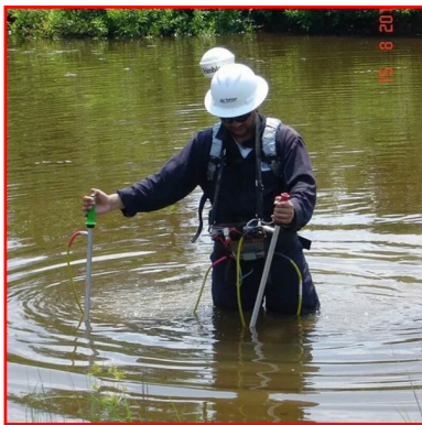
Figura 1. Evaluación de Revestimiento mediante DCVG/GNSS Oleoducto de 10" Sucumbios-Ecuador Tractopipe 2013.
