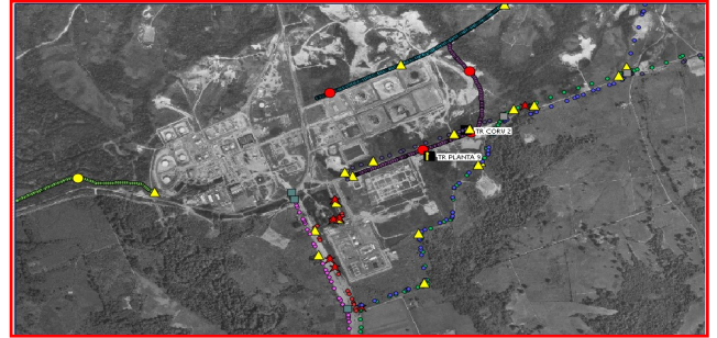
Figura 3. Ubicación de anomalías en SIG de integridad mecánica. Tractopipe 2017.
